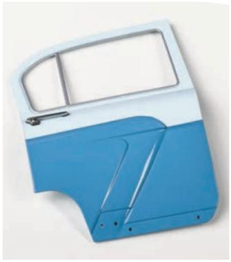
Расположите внешнюю ручку под проемом неподвижного окна задней правой двери модели. Совместите крепежные и центровочные элементы ручки с ответными отверстиями двери и зафиксируйте ручку с внутренней стороны двери винтом 2,0×4 (ВМ).
